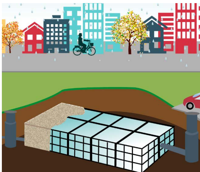
Figur 14 Principskiss för ett underjordiskt fördröjningsmagasin.
